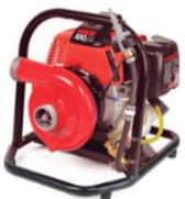
**Motobomba Wick 100M:** MOTOBOMBA ULTRALIVIANA DE ALTO RENDIMIENTO con un peso 8.4 kg y operada con un motor de 2 tiempos, de 2,4 CV / 1,8 Kw (47 cc) y bomba que alcanza una presión máxima de 100 PSI y un caudal máximo de 303 litros por minuto. Esta bomba está diseñada específicamente para el combate de incendios forestales: bomba de simple etapa y compatible con uso de espuma.
