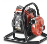
**Motobomba Wick 375:** MOTOBOMBA DE 4 ETAPAS DE ALTA PRESIÓN RENDIMIENTO con un peso 25.4 kg y operada con un motor 2 tiempos; de 10 HP (210 cc) y bomba que alcanza una presión de 400 PSI y un caudal máximo de 379 litros por minuto. Esta bomba está diseñada específicamente para el combate de incendio forestales: bomba de cuatro etapas y compatible con uso de espuma.
