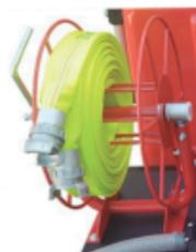
4 seções de mangueira flexível com 3 camadas de 25 mm de diâmetro e 20m de comprimento por seção com encaixe barcelona de alumínio estampado de 25mm nos extremos.
